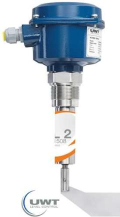
Gli interruttori a paletta Rotonivo® possono essere utilizzati come rilevatori di pieno, vuoto o su specifica in silos di prodotti solidi di piccole dimensioni, polverosi e fangosi, anche con tendenza a formare depositi.
